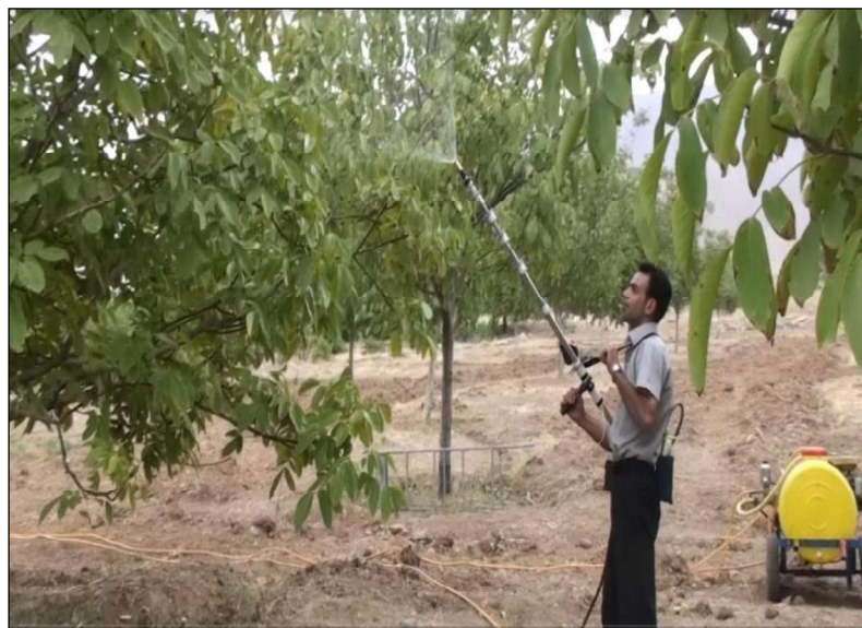
شکل ۵. سمپاش مجهز به بوم تلسکوپی در حال سمپاشی Fig.5. The sprayer equipped with telescopic boom being sprayed
