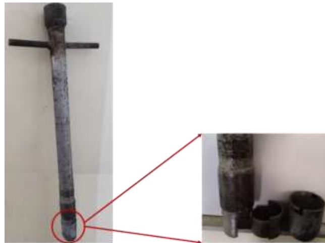
شکل ۲- دستگاه نمونه‌برداری خاک دست‌نخورده Figure2. Core sampler for intact soil sampling
