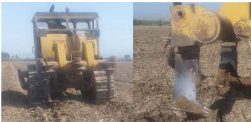
شکل ۱- نحوه انجام عملیات زیرشکن‌زنی توسط بولدوزر-D8 Figure 1. Subsoiling operations with bulldozer-D8
