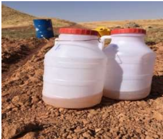
شکل ۲- نمایی از آزمایش تولید رواناب و رسوب در جویچه‌های ایجاد شده
