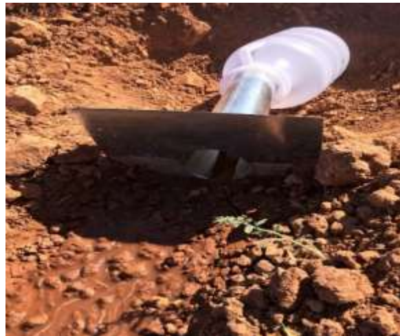
شکل ۲- نمایی از آزمایش تولید رواناب و رسوب در جویچه‌های ایجاد شده
