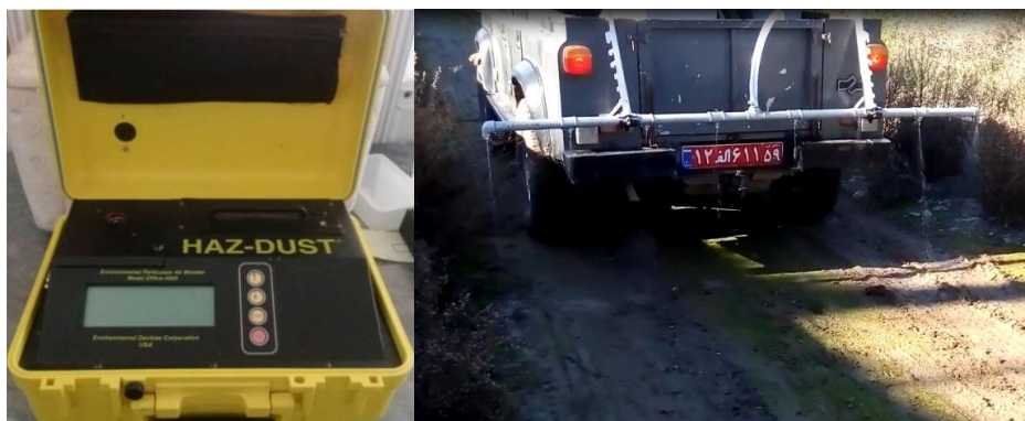
شکل ۳- (الف) سیستم اسپری محلول‌های ضد غبار و (ب) دستگاه غبار سنج مدل HAZ-DUST EPAM-5000 Figure 3. (a) Anti-dust agent spray system, (b) Dustometer instrument HAZ-DUST EPAM-5000
