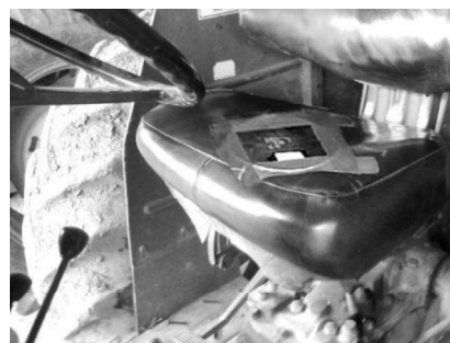
شکل ۲. ارتعاش سنج مورد استفاده (مدل SV100) و نحوه قرارگیری آن روی صندلی تراکتور Fig 2. Triaxial accelerometer (model SV100) and its placement on the tractor seat
