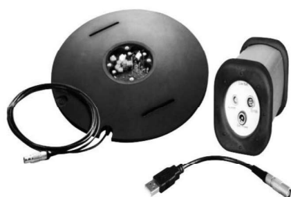
شکل ۲. ارتعاش سنج مورد استفاده (مدل SV100) و نحوه قرارگیری آن روی صندلی تراکتور Fig 2. Triaxial accelerometer (model SV100) and its placement on the tractor seat
