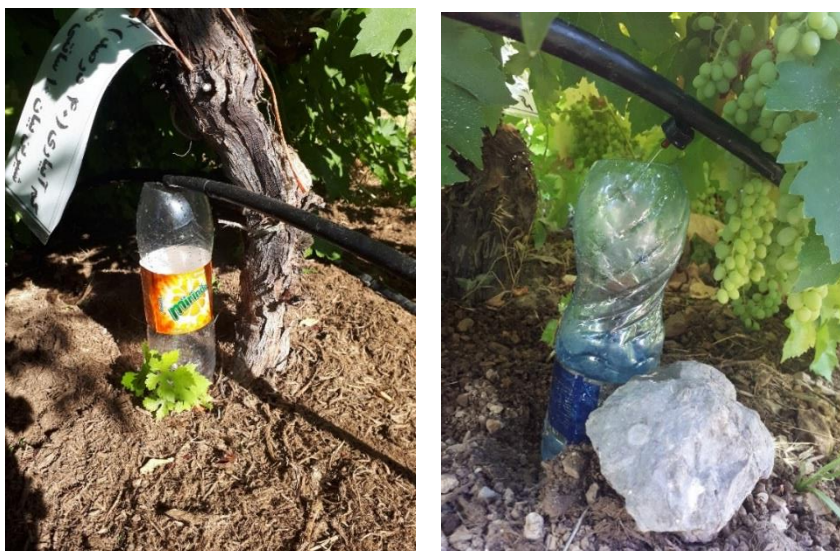
شکل ۲- اندازه‌گیری دبی قطره چکان‌ها (عکس: مجری طرح)
