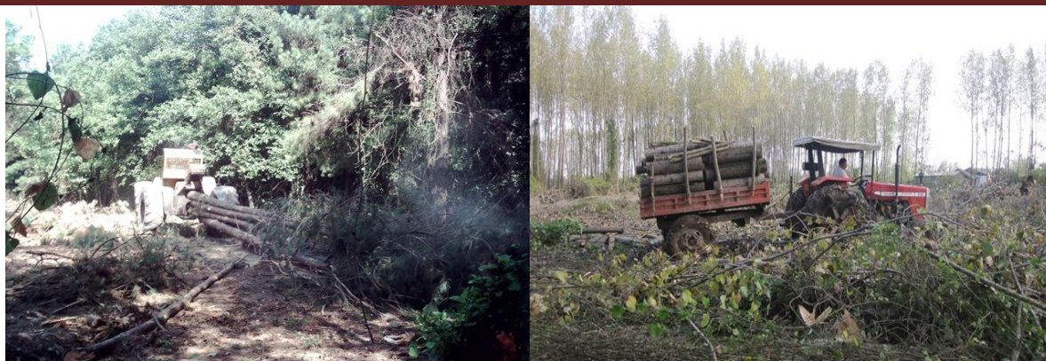
شکل ۲- تصویر ماشین‌آلات مورد استفاده برای چوبکشی به روش چوب کوتاه (تراکتور کشاورزی، تصویر سمت راست) و تمام درخت (اسکیدر چرخ لاستیکی تصویر سمت چپ)
