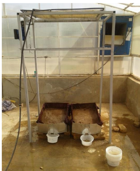
شکل ۲- نمایی از دستگاه شبیه‌ساز باران مورد استفاده در پژوهش Figure 2. View of the rainfall simulator used in the research
