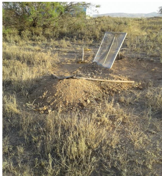
شکل ۱- نحوه نمونه‌برداری خاک از عمق صفر تا ۳۰ سانتی‌متری
