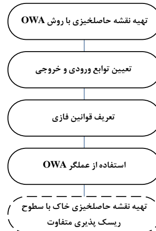
شکل ۱- مراحل تعیین حاصلخیزی خاک با استفاده از روش میانگین وزنی مرتب شده (OWA)
