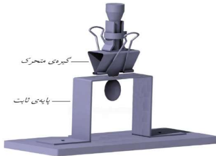
شکل ۵. آزمون جدایی دم از حبه
