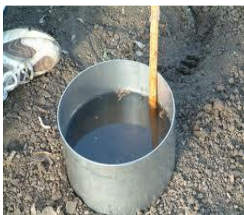
شکل ۳- روش تک استوانه برای اندازه‌گیری نفوذپذیری آب در خاک
