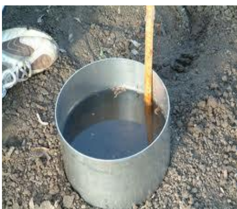
شکل ۳- روش تک استوانه برای اندازه‌گیری نفوذپذیری آب در خاک
