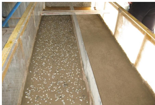
شکل 1- نمائی از فلوم مورد استفاده و توزیع سنگریزه‌ها بر روی سطح بستر خاک
