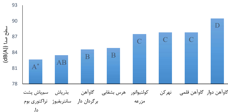
شکل ۵. نتایج آزمون چند دامنه‌ای دانکن تأثیر نوع وسیله بر dB(A) (موقعیت ناظر، *: مقادیری که با یک حرف مشخص شده‌اند تفاوت معناداری در سطح ۱ درصد ندارند)
