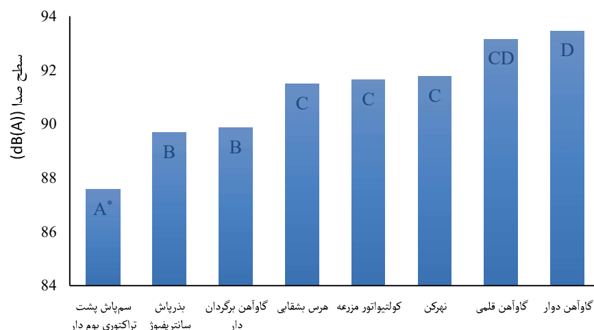
شکل ۴. نتایج آزمون چند دامنه‌ای دانکن تأثیر نوع وسیله بر dB(A) (موقعیت راننده، *: مقادیری که با یک حرف مشخص شده‌اند. تفاوت معناداری در سطح ۱ درصد ندارند)
