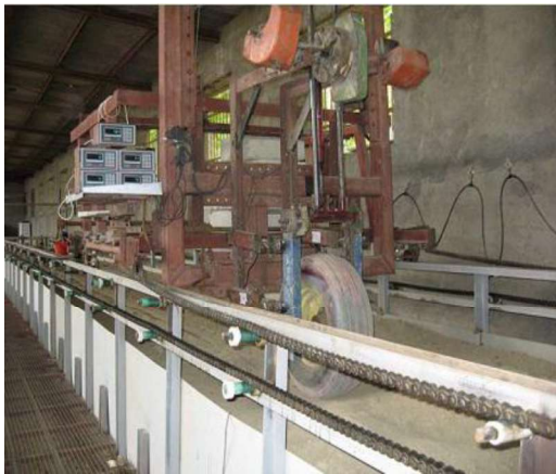
شکل ۱- نمای کلی سیستم داده برداری شامل انباری خاک،
